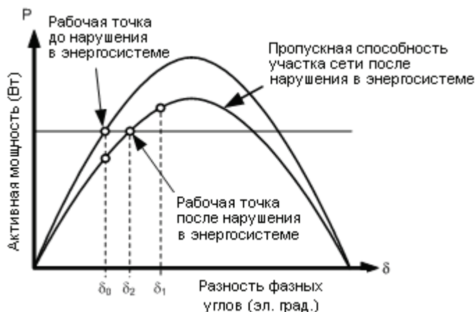
Рис. 2: Предельно возможная передаваемая активная мощность в основном определяется разностью фазных углов \delta и индуктивным сопротивлением линии связи X_L при номинальных значениях E_A , E_B
